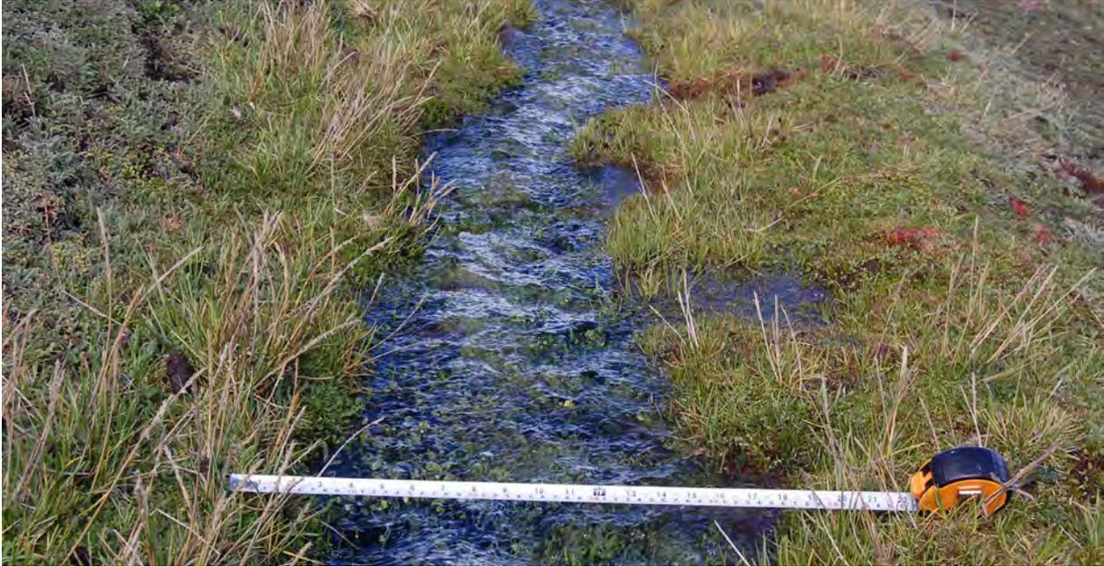
Figura N° 21: Aforo de caudal en materiales coluviales
